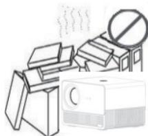
Installieren Sie das Gerät nicht in einem schlecht belüfteten Bereich.
