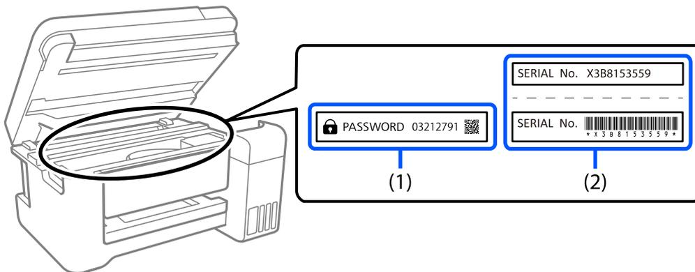
Wenn Typenschild (1) und (2) angebracht sind, ist der neben PASSWORD notierte Wert am Typenschild in (1) der Standardwert. In diesem Beispiel lautet der Standardwert 03212791.
